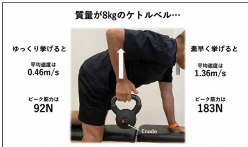
図1 ケトルベルにEnodeを取り付け、ワンハンドロウにおける速度と力を低速と高速で比較
