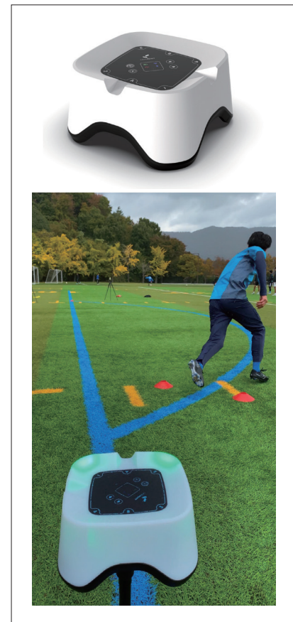
本体を一台設置するだけで、スプリント、アジリティー、曲線走等のスピード変化が簡単に取得できる。
