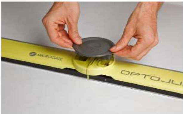
Fig.16.17-キャップを地面と平行にしたまま軽く押し組む
