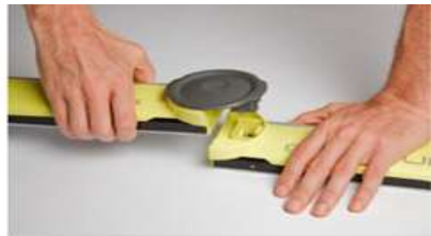
Fig.19-キャップをはずすもう一つの方法
